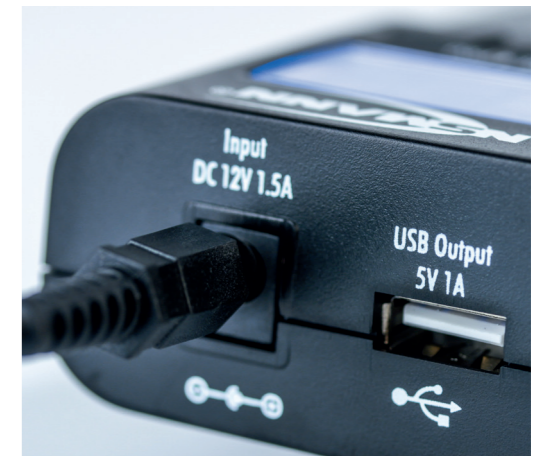
Kompatibel mit USB-Geräten Compatible with USB devices
